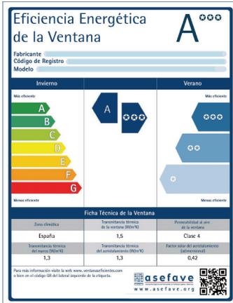
El coeficiente  $U_w$  de la ventana depende del acristalamiento empleado y el valor  $U_f$  de los perfiles. El valor  $U_f$  de PremiDoor dependiendo de la combinación de hoja y marco empleada es de **1,7 W/m²K**.
